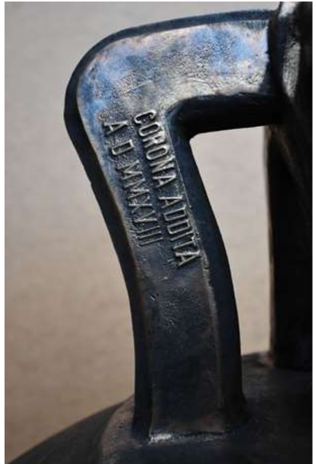
Neueingeschweißte Krone einer mittelalterlichen Glocke von 1354; Neunhofen; Saale-Orla-Kreis (Foto: M. Schmidt)
