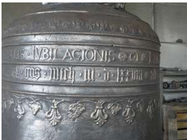
Durch Abbürsten entstellte Glockenoberfläche mit abgeglätteten Konturen (Foto: A. Philipp)
