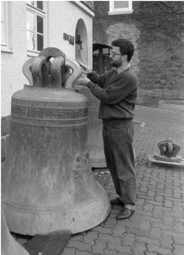
Anpassung eines Kronenhenkels nach Vorbild der erhaltenen Henkel (Fotos: C. Peter)
