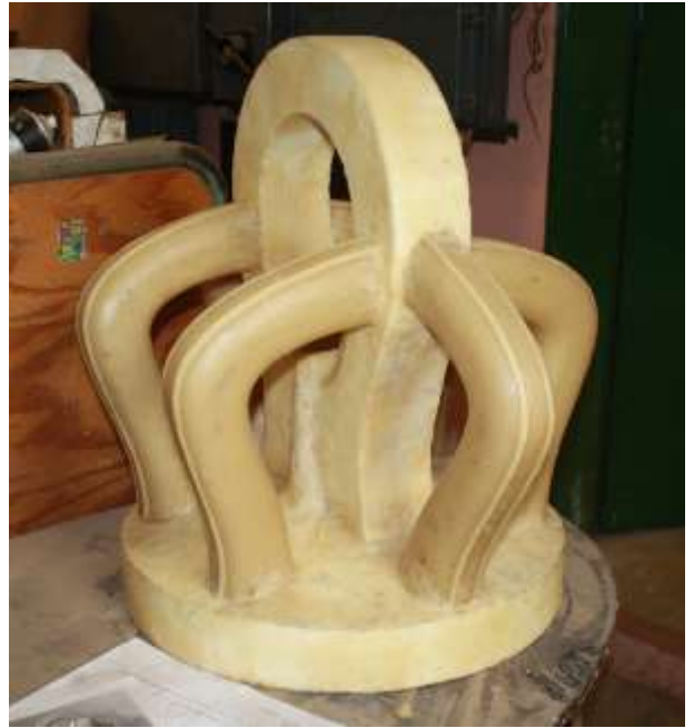
nach zeichnerischer Vorlage von der Glockengießerei gefertigtes Wachsmodell (Foto: C. Peter)
