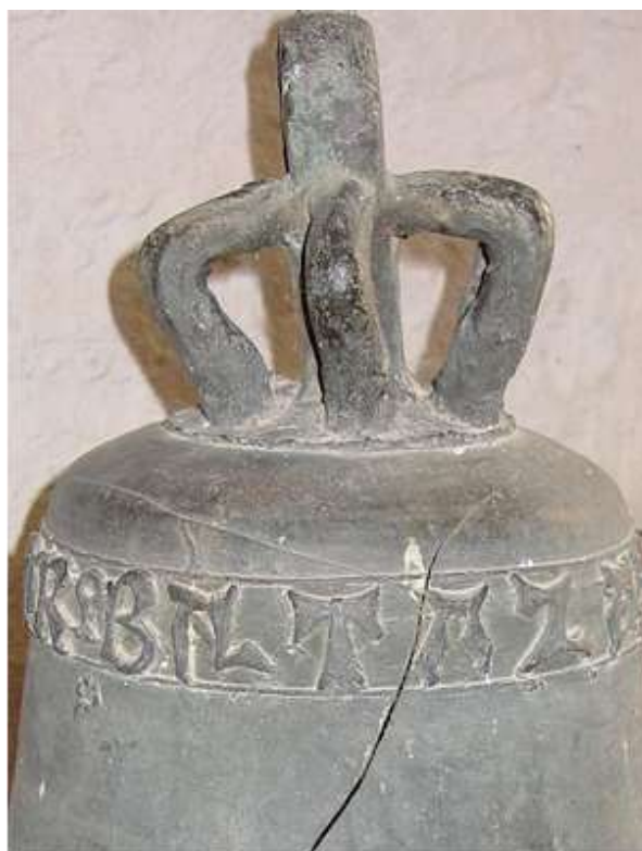
Riss durch die mittelalterliche Inschrift (Foto: M. Schmidt)
