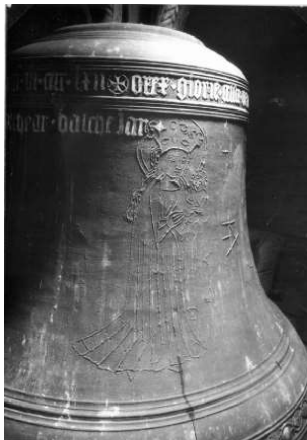
Ein durch eine Ritzzeichnung verlaufender Sprung (Foto: C. Peter)
