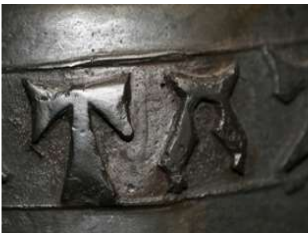
Durch Nachziselierung wiederhergestellte Inschrift (Foto: B. Mai)
