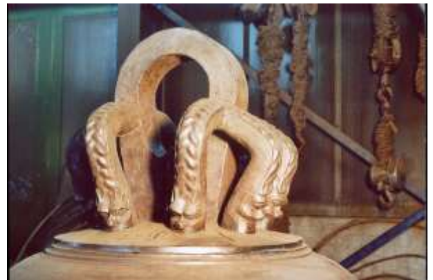
Abgeformte, gegossene und einschweißte Krone (Foto: C. Peter)
