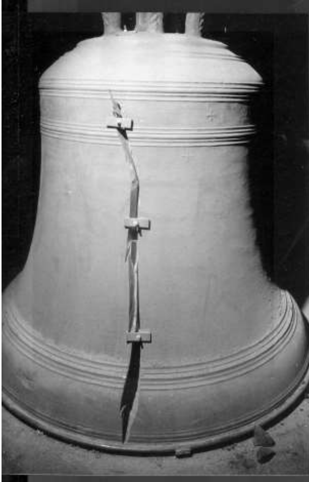
Zum Schweißen vorbereitete Glocke (Foto: C. Peter mit frdl. Genehmigung der Fa. Lachenmeyer)
