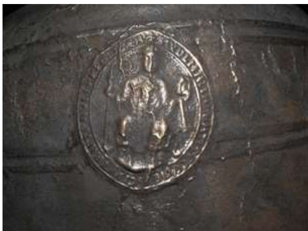
Durch Abbürsten entstellte figürliche Darstellung mit abgeglätteten Konturen (Foto: A. Philipp)
