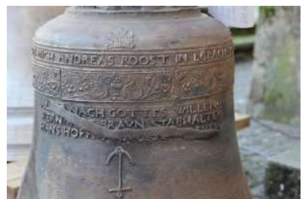
Ebenfalls Schweißung durch eine Inschrift ohne nachträgliche Wiedererkennbarmachung des Textes (Foto: Johannes Lang).
